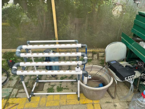
Gambar 4. Implementasi Sistem Monitoring dan Kontrol pH Berbasis IoT pada Instalasi Hidroponik NFT
