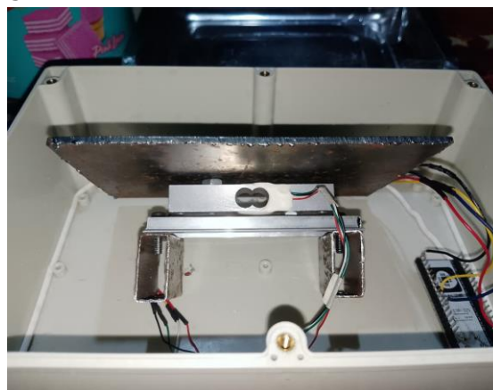
Gambar 11. Penerapan Rangkaian ESP32, Load Cell, dan HX711
