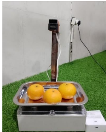
Gambar 13. Perakitan Prototipe Timbangan Digital
