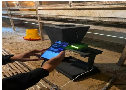
Gambar 3. Implementasi alat pemberian pakan ayam otomatis di kandang
