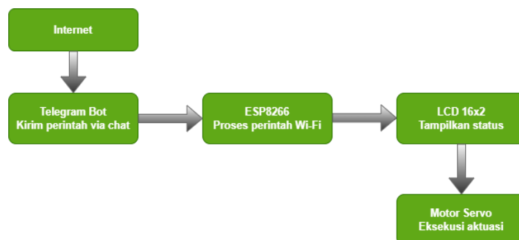
Gambar 2. Blok Diagram Sistem Pemberian Pakan Ayam Otomatis
