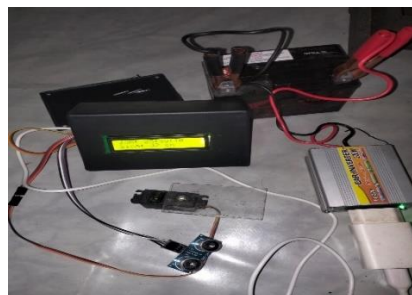
Gambar 7. Pengujian sistem menggunakan aki sebagai sumber daya cadangan.
