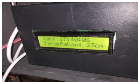
Gambar 5. Tampilan LCD ketika sistem aktif
