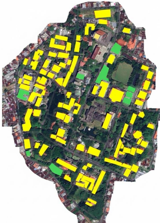
Gambar 5. Pembagian lokasi optimal pemasangan panel surya
