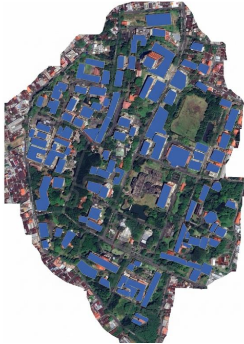
Gambar 4. Area potensial pemasangan panel surya yang ditandai dengan warna biru.
